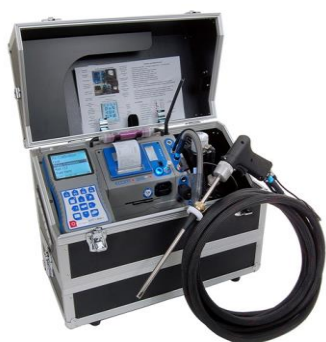
Analyseur de fumées portatif utilisé par ATANOR
