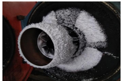
Brûleur encrassé par les particules d'un combustible alternatif
