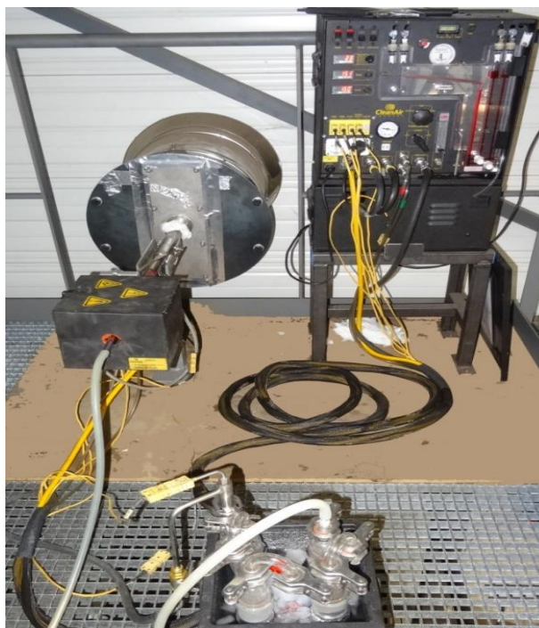
Analyseur de poussières monté sur la chaudière d'essais d'ATANOR
