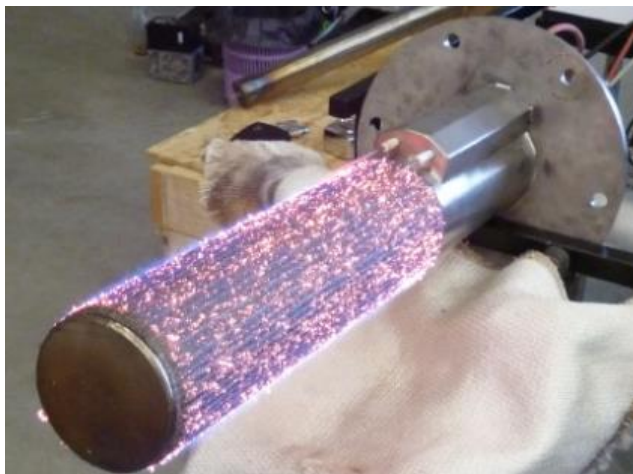
Brûleur à support poreux en fonctionnement à l'air libre
