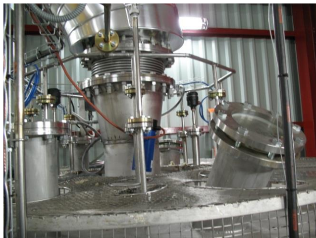
Vue de la partie supérieure d'une chambre de combustion équipée du brûleur à support poreux
