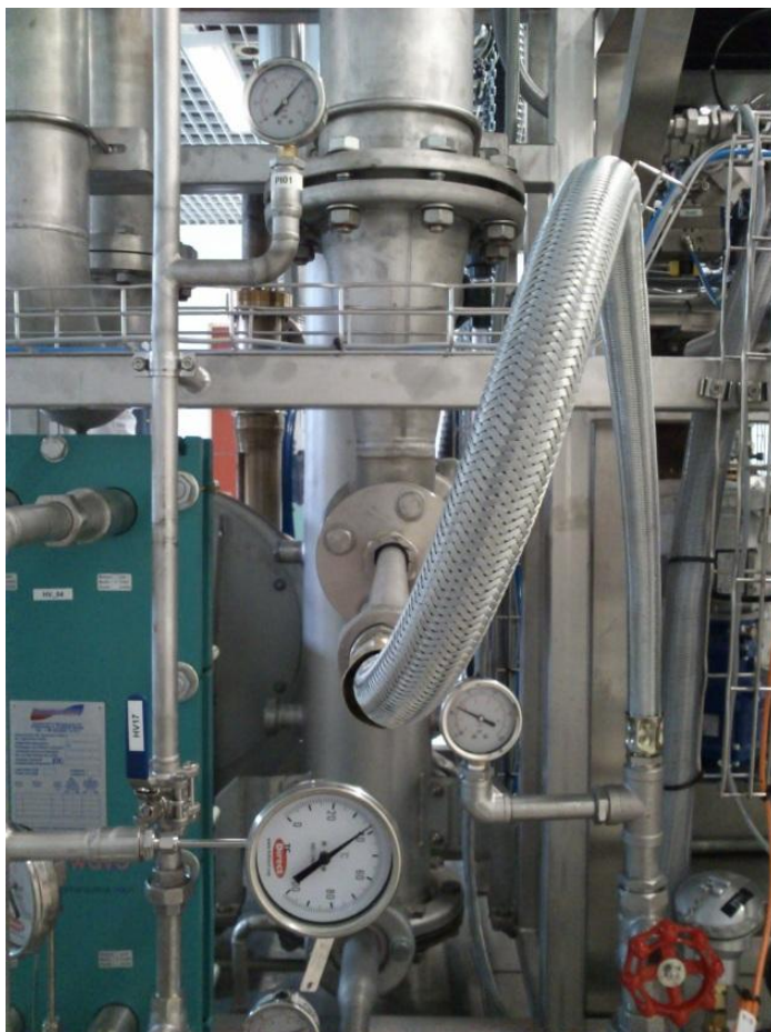
Système d'épuration de syngaz sur une unité pilote de gazéification de biomasse
