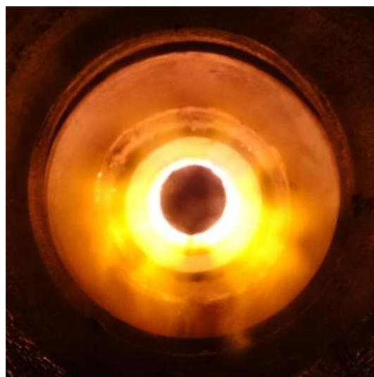
Test de combustion avec un brûleur à support poreux alimenté avec du syngaz
