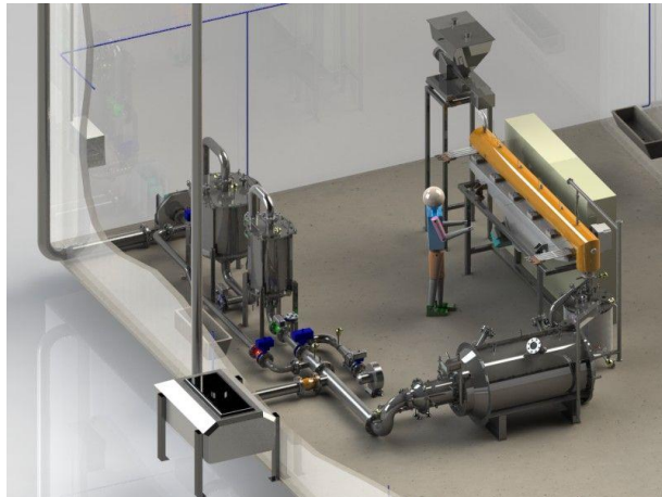
Vue 3-D du pilote THERMOCOM pour l'étude de la désorption thermique ou de la pyrolyse de matériaux solides
